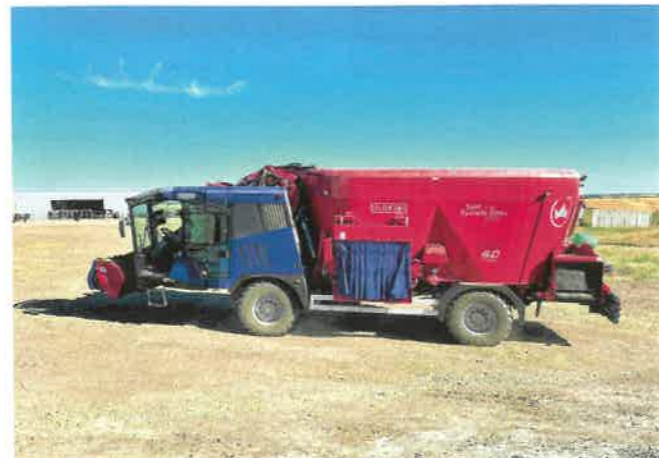
Med 4WD med en 50/50-fordeling af trækraften på forreste og bagerste aksel er Siloking rustet til vinter, mudder og bakker.
